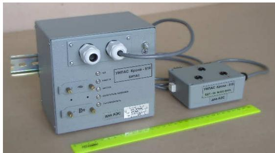
Стационарная система «КРОНА-516» (УИПАС) накапливает данные для последующей передачи на АРМ (сервер) или в мобильную систему диагностики (ноутбук). Передача данных может осуществляться в автоматическом режиме по вычислительной сети (Ethernet-кабелю), или через USB-флешдиск. В автономном режиме работы общее время регистрации параметров – до 7 часов работы запорно-регулирующей арматуры.
